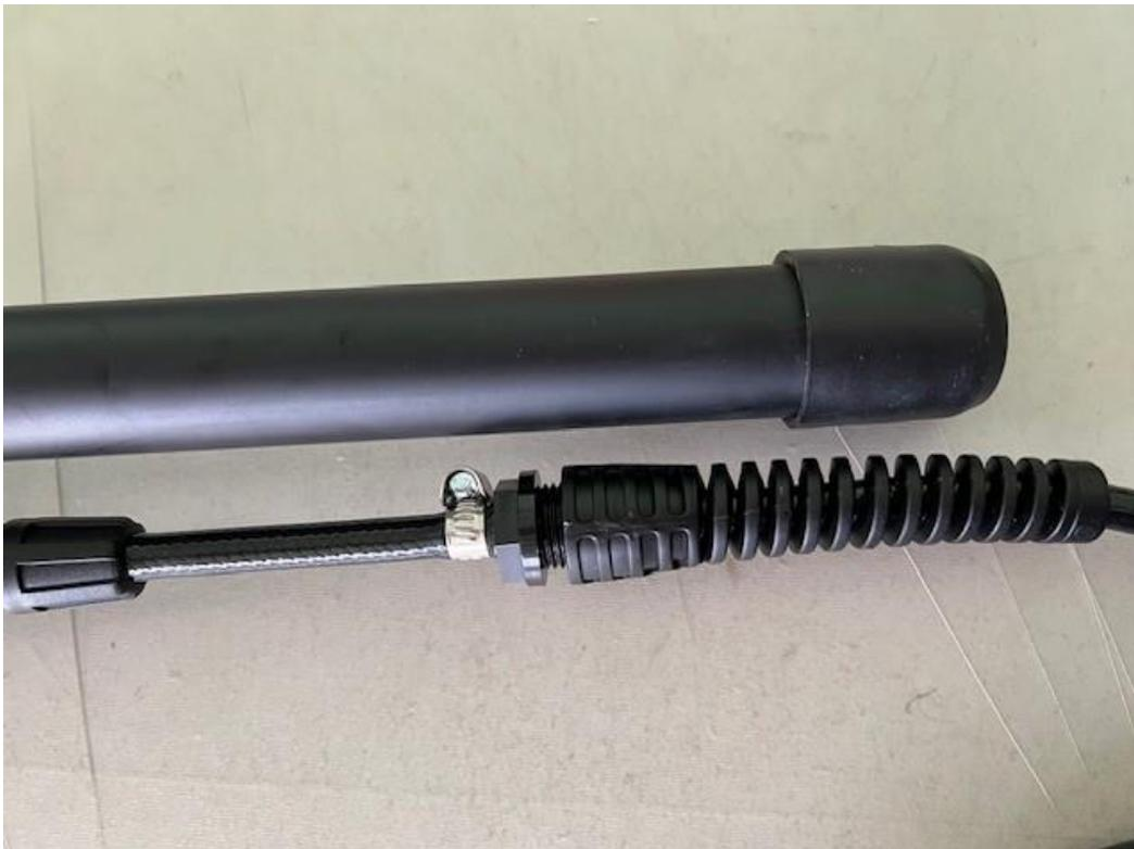
Danach wird die schwarze Verschraubung des Schlauches am Adapter der Lanze festgedreht.
