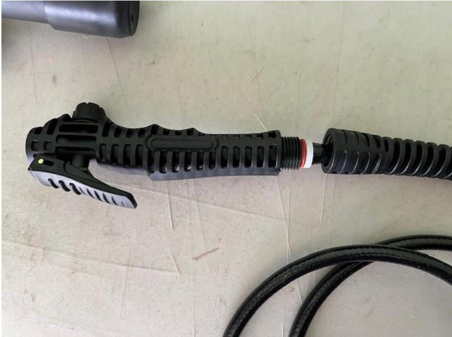
Der Dosiergriff von dem Drucksprüher muss abgeschraubt werden. Der weiße Stecknippel im Schlauch muss drinbleiben.
