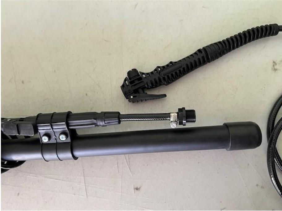
Oben befindet sich der Schlauch inkl. Dosiergriff von dem Drucksprüher. Im Unteren Bereich ist das Ende von der KWT500 Teleskoplanze
